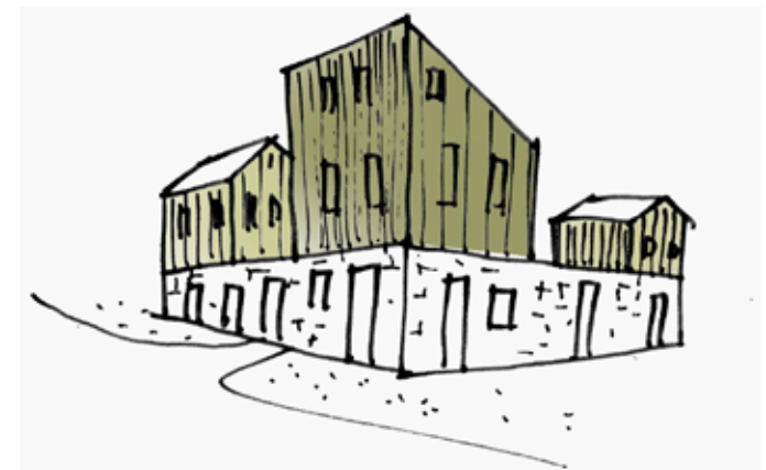
Binnenblok metselwerk plint met houten woningen erboven
